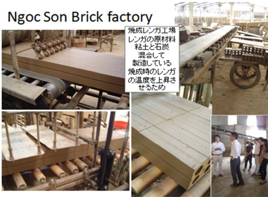
写真 添付①-30. 焼成レンガの焼成前成形状況
