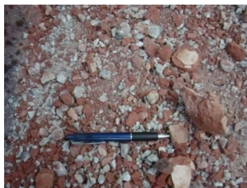
写真 4.2.2-3 破碎された混合建廃
