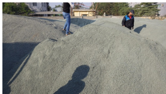
写真 4.2.1-2 Toan Cau Building Materials 非焼成レンガ工場の石灰岩系の原料
