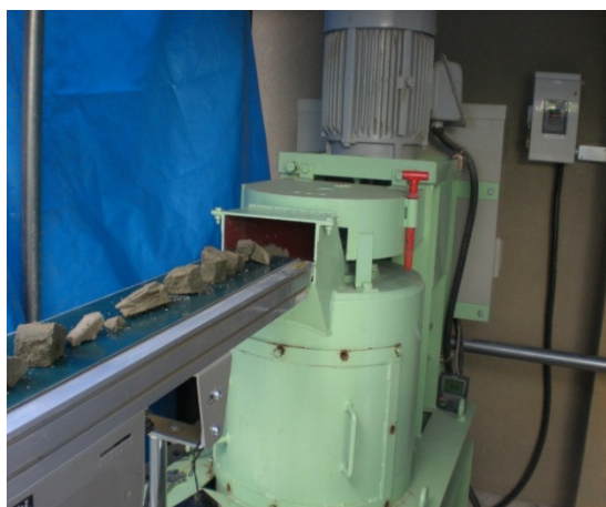
(a)小型回転式破碎混合機全体
