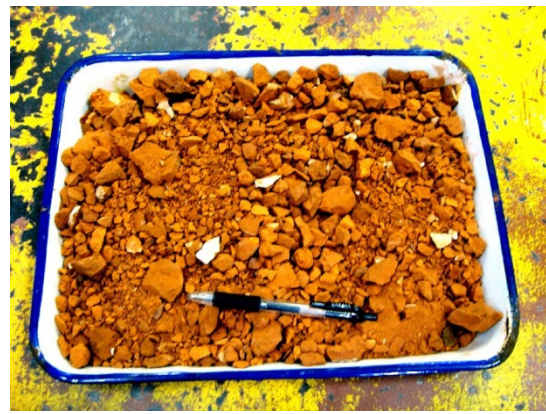
写真 4.2.2-7 破碎後のレンガ廃材
