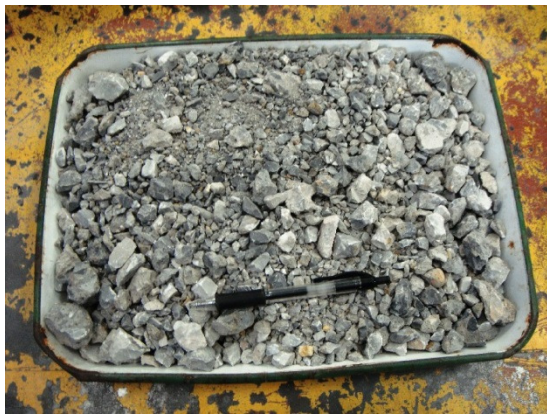
写真 4.2.2-6 破碎後のコンクリート廃材
