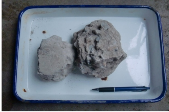
写真 4.2.2-4 コンクリート廃材
