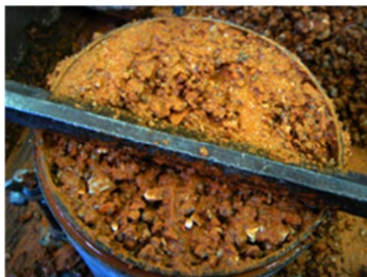
写真 4.2.2-9 最適含水比付近の 試料の締固め状況
