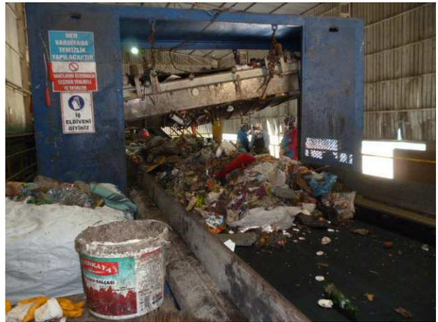
図 2-3-24 Gebze 中継施設 (磁力選別機)
