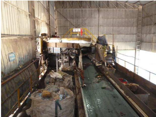
図 2-3-23 Gebze 中継施設 (手選別コンベヤ)
