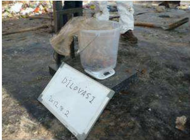
図 2-4-8 単位体積重量測定
