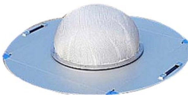
図表 117 風車音測定用風防(円板直径 1m)
