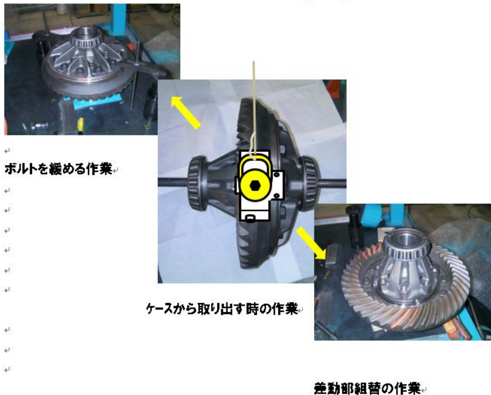
図表 23 リングギヤ取出し補足図2
