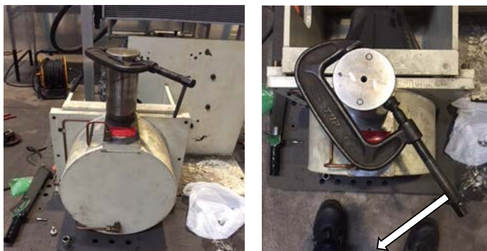
図表 47 プロト1号機 白矢印の方向にプルゲージで引っ張り測定
