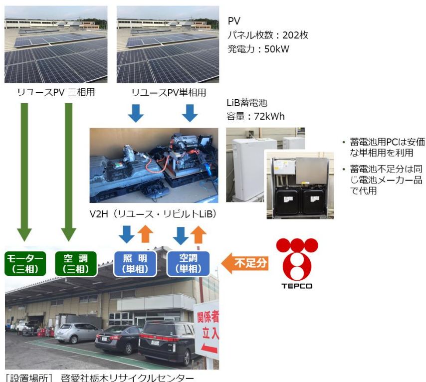
図 2.2.1 低炭素電力システムの設置状況
