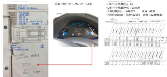
図 3.2.3 CONSULT 診断 (車両故障診断装置) から取得した LiB パック・モジュールに関する情報
