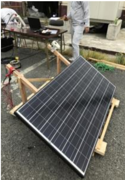
写真 4.2.2 I-V チェッカーを用いた PV モジュール検査用の検査台
