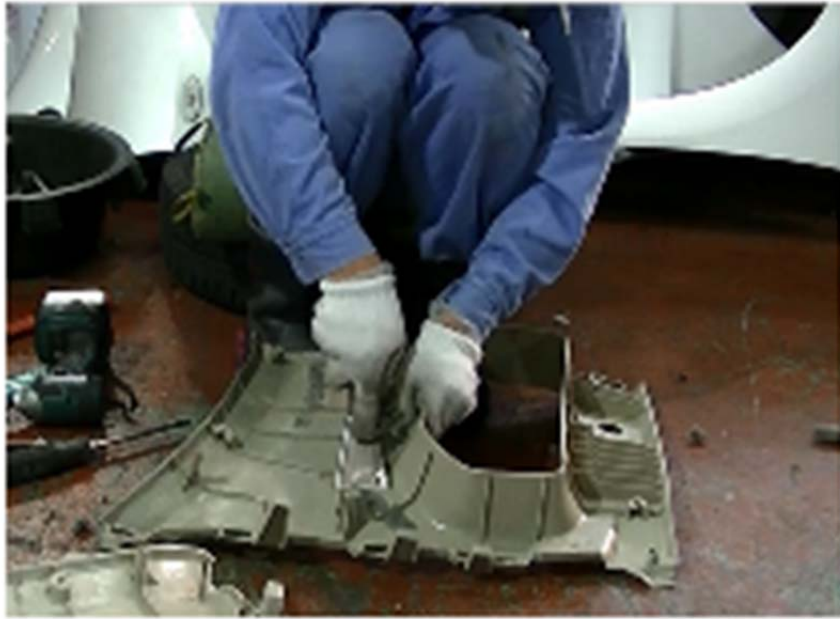
◆ピラー（内張り）の二次解体の様子
