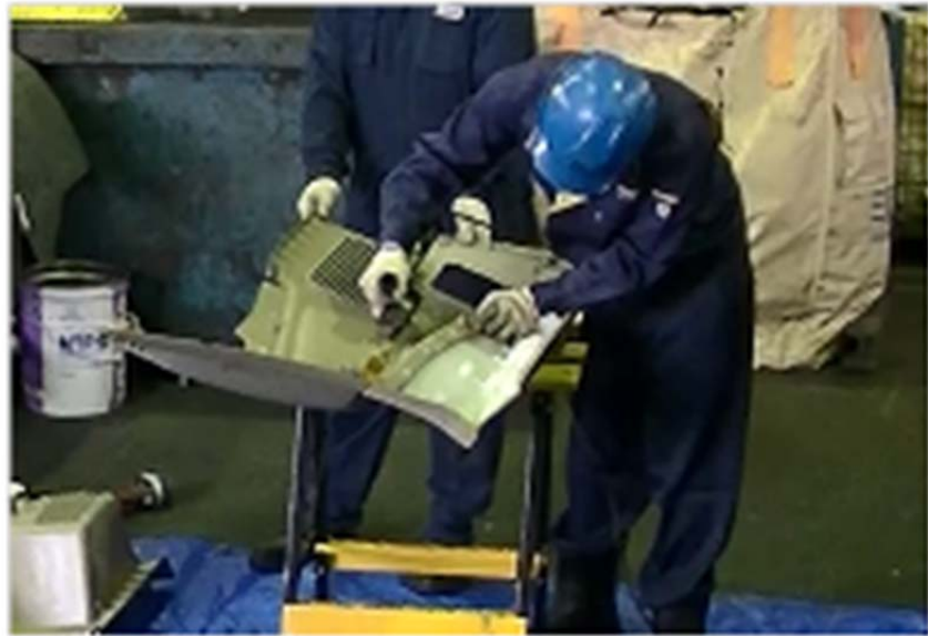
◆接着剤付着部分をダイヤモンドカッターで切り分ける様子
