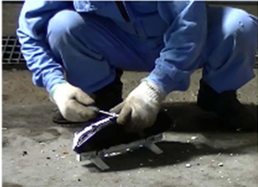
◆スピードメーター二次解体の様子
