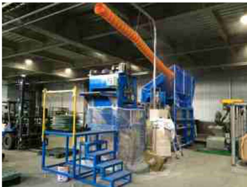
図 3-3 フロントガラス処理機（全景）
