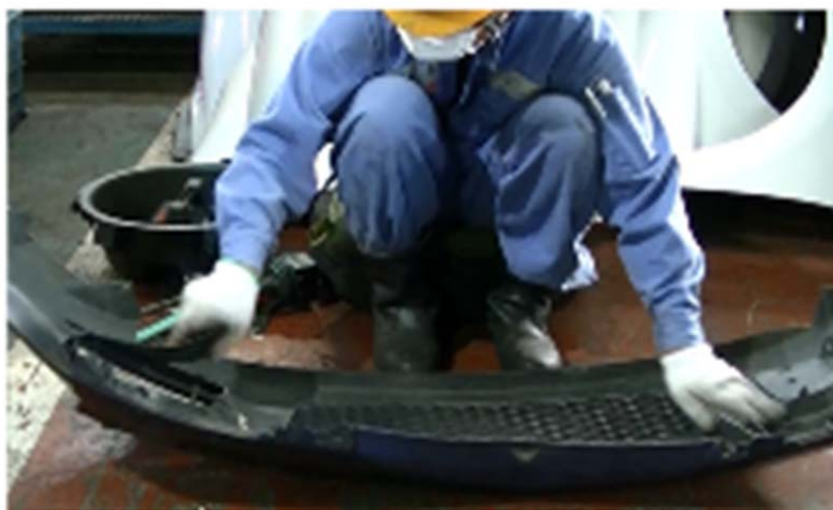
◆バンパー（フロント）の二次解体の様子
