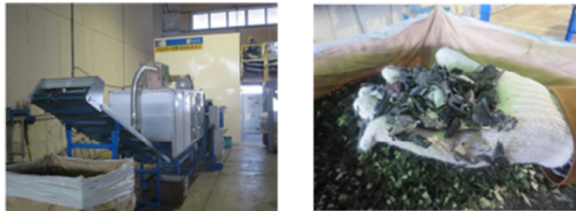
図表 4-8. 本事業で使用した破砕ライン全景と製造した破砕材
