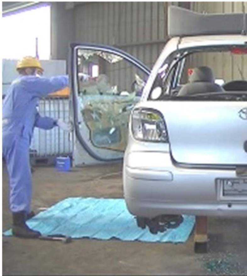
◆大きめのブルーシートを敷くことで破碎後回収にかかる時間を短縮することができる。
