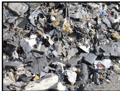
図 3.1.3-19 破碎粒度大の受入A S R ( 2 ) の夾雑物混入状況
