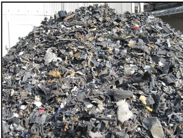
図 3.1.3-18 破碎粒度大の受入A S R ( 2 ) の荷姿
