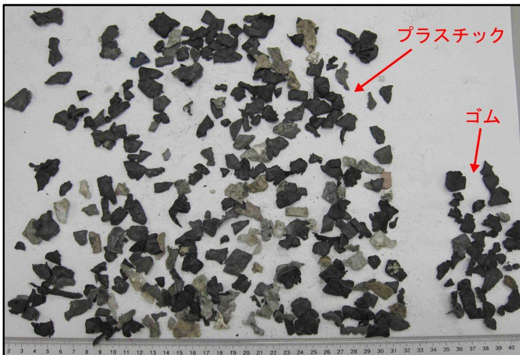
図 3.1.3-10 水浮き A S R 由来プラスチック中の残存夾雑物
