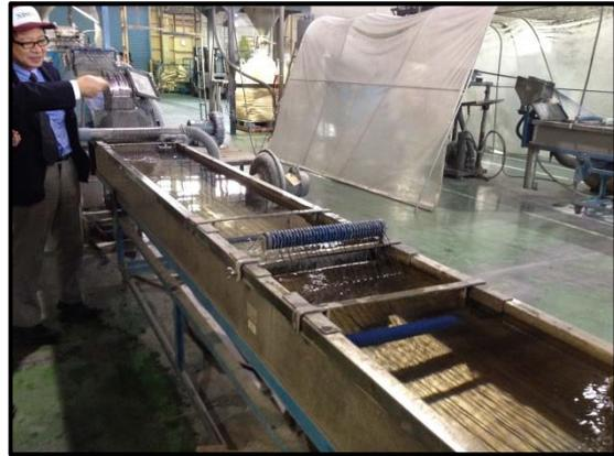
図 3.4.1-4 リペレット試験状況 No4
