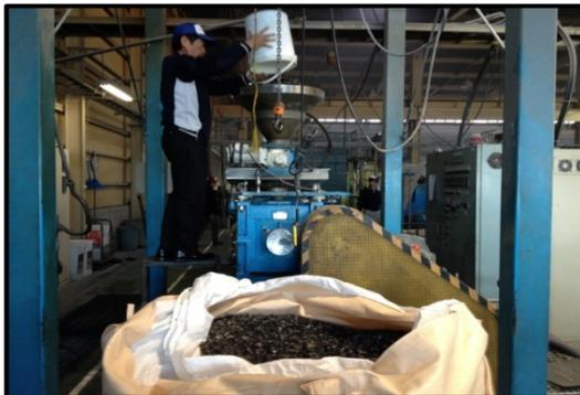
図 3.4.1-1 リペレット試験状況 No1
