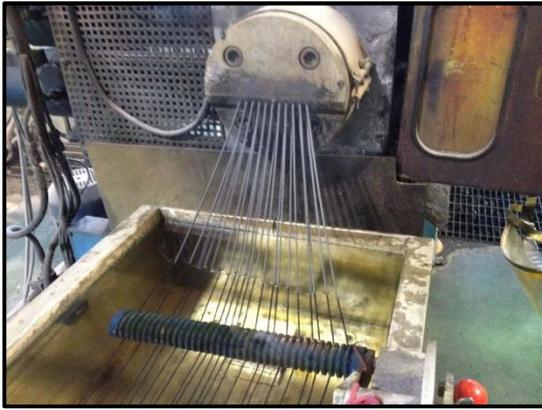
図 3.4.1-3 リペレット試験状況 No3
