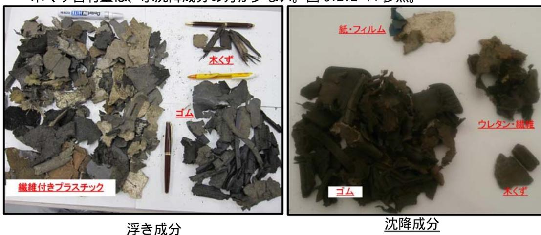
図 3.2.2-14 水比重浮き成分/沈降成分中の木くず含有比較
