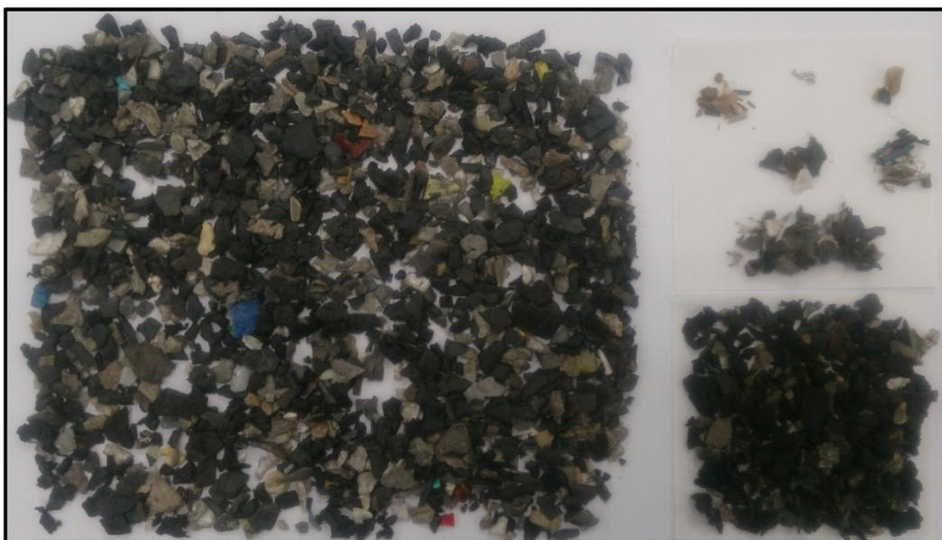
図 3.1.3-26 破碎粒度小の受入ASR 夾雑物混入比率分析
