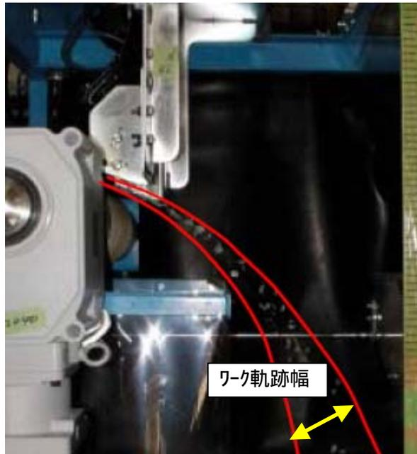
図 3.3.2-7 ワークの飛行軌跡幅
