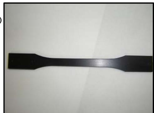
図 3.4.1-6 材料物性試験片
