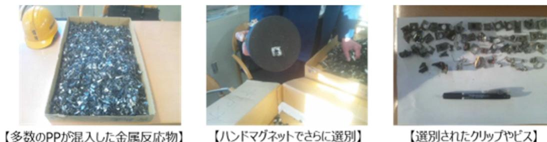
金属センサーによって大きい異物の除去は達成できたと考えられるため、本材料を再度いそので品質評価を実施した。しかし、YAMANAKA での破碎材はエコアールでの比重選別後の状態から引き続き水分を多量に含んだままであり、水分によって破碎材が密着することでブリッジ状態が悪化し、攪拌機への投入すら困難な状態であった。そのため、押出工程においても熔融時に多量の水分が水蒸気となり、歩留まり低下等の加工不具合が発生した。
