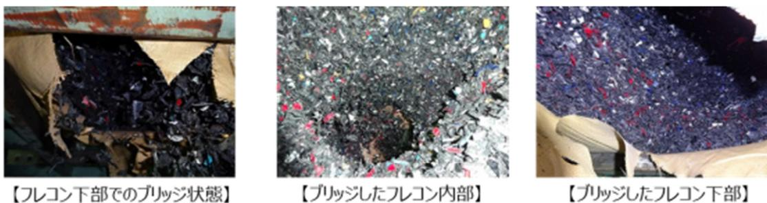
図表 5-4. 原料タンクから吸上げ時のブリッジ現象の様子
