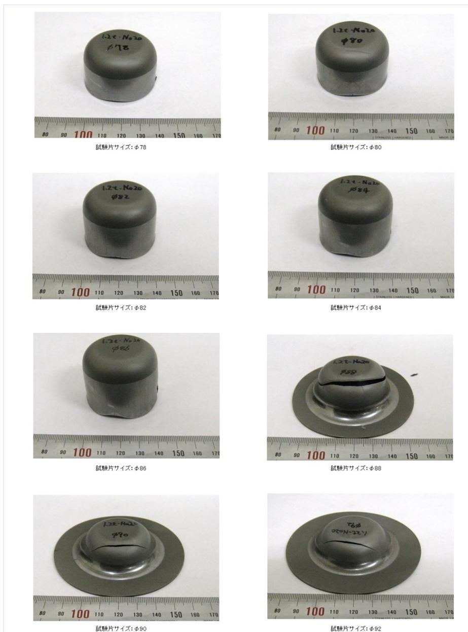
図 65.7 深絞り試験片の外観写真 (1.2mm No20)
