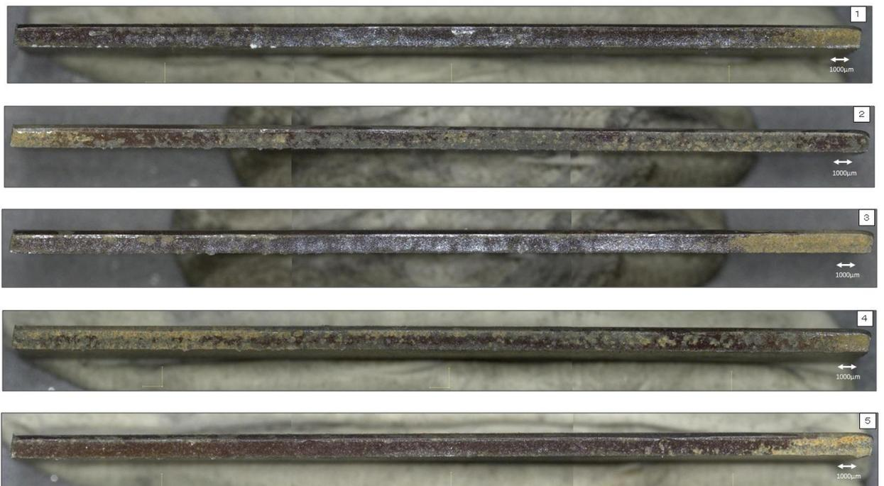
図 64.3 シャー断面外観写真 1.4mm 72h
