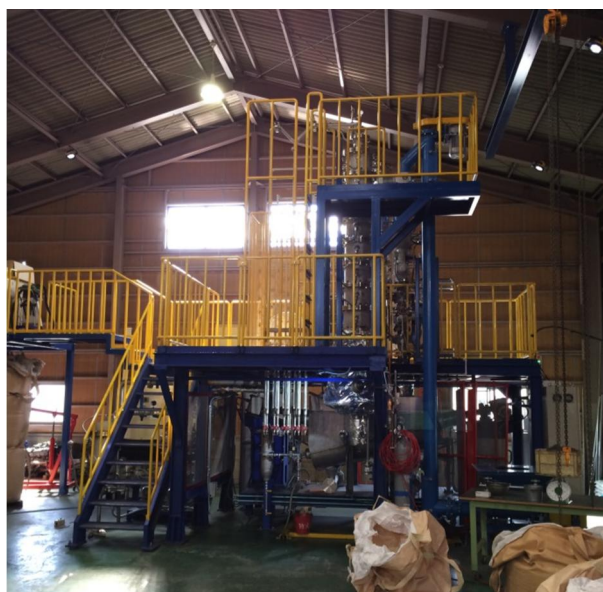
図 4-3 接触分解方式による油化プラント
