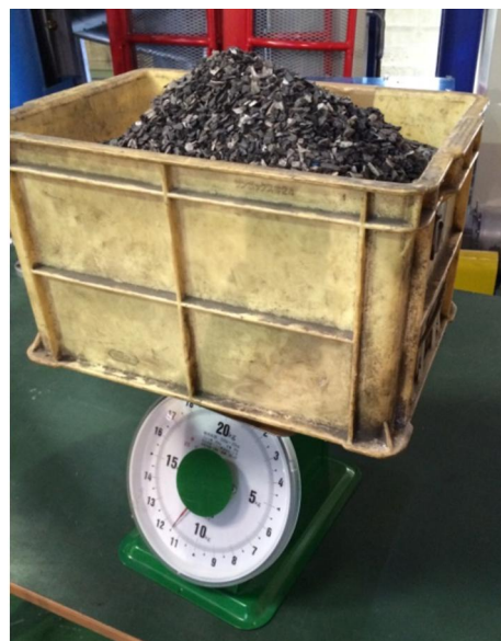
図 4-4 投入した ASR プラ
