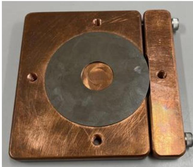
図表 II-23 アルミメディア剥離試験（電気パルス）における治具全体構造
