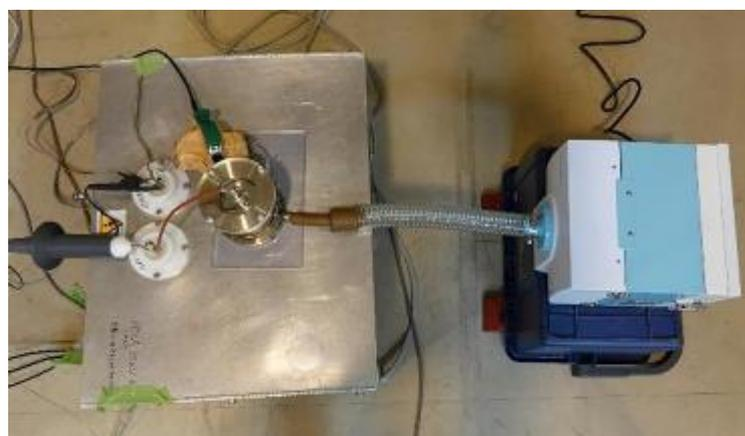
図表 II-32 Blumlein 電源使用時の電極イメージ
