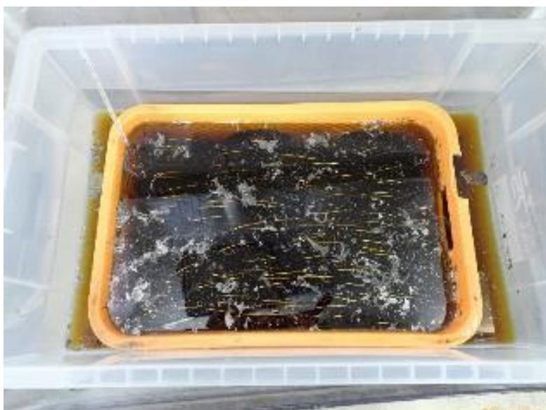
図表 II-16 溶解中アルミメディア（硝酸溶液）
