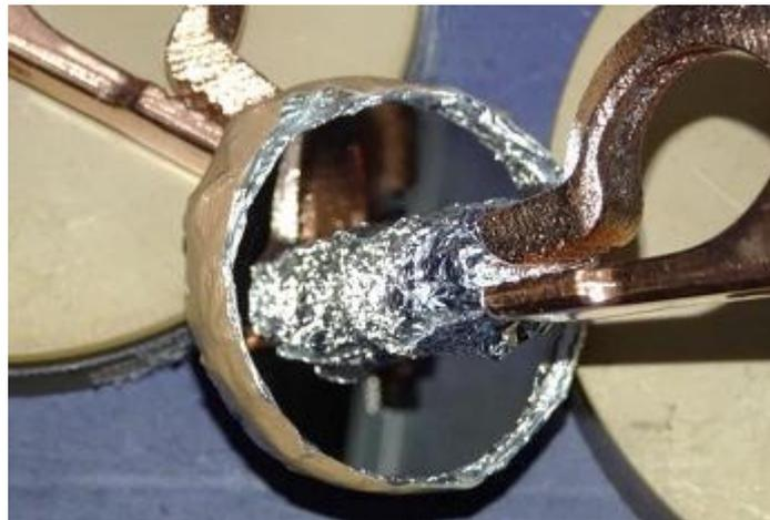
図表 II-27 ガラスメディア剥離試験（電気パルス）における治具全体構造
