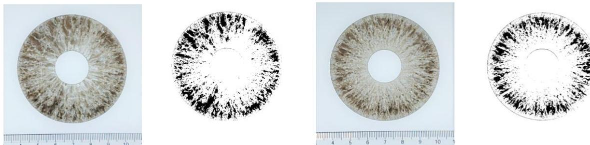
続いて、倍電圧回路と Blumlein 電源による剥離の比較結果を示す。剥離面積については大きな差はみられなかったが、Blumlein 電源においては消費エネルギーが少なく、より効率的な剥離
