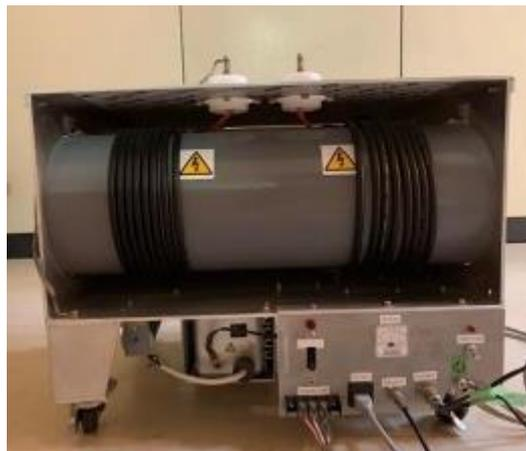
図表 II-31 Blumlein 電源を使用した装置概観
