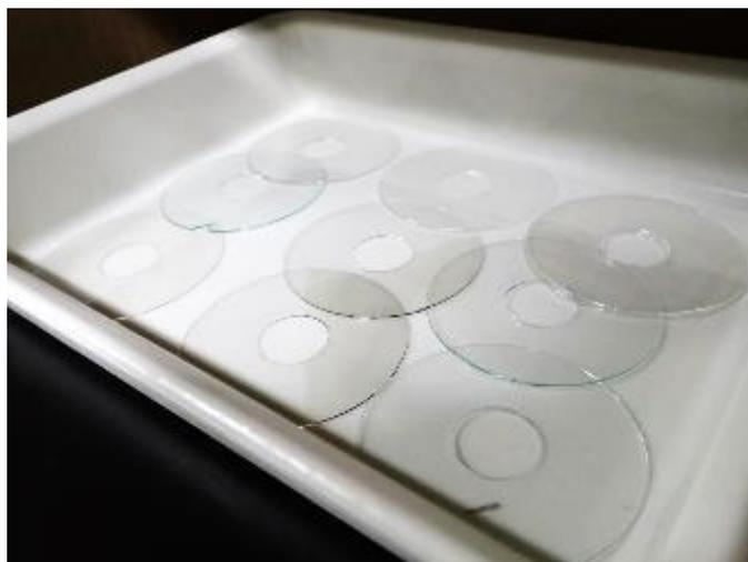
アルミメディアについては、メディア表層に DLC 層が存在し、溶液の浸透を妨害するために時間がかかることから、前処理としてアルミメディアを塑性加工し、DLC 層に亀裂をいれることで、反応時間の短縮を図った。その後溶解溶液として酸溶液を使用し、金属層を溶解することで膜剥離を行った。浸漬時間は約 1.5 時間であった。剥離後のアルミメディアの表面を簡易 XRF にて測定したところ、Ru および Pt が検出されなかったため、剥離に成功したと判断した。
