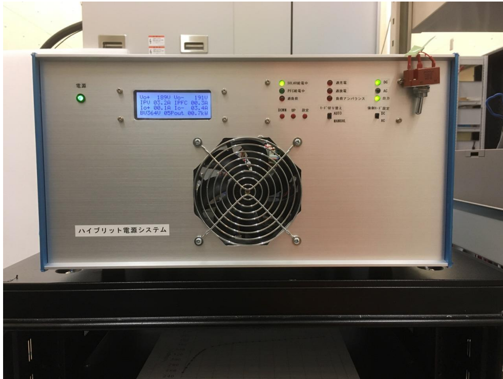
図 2-1-1-18. 直交流ハイブリッド電カシステム BMU
