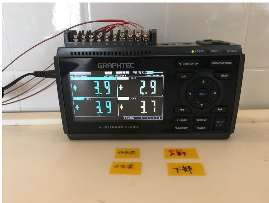
図 2-1-1-41. 外気温(左上)、筐体内温度(左下)、バッテリーセル表面温度(右上)、バッテリーパック表面温度(右下)
