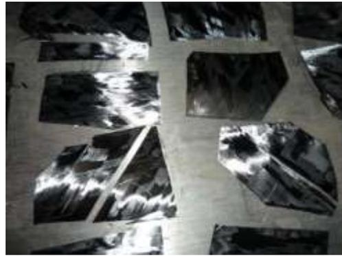
図 3.32 燃焼処理後の航空機端材の表面の様子
