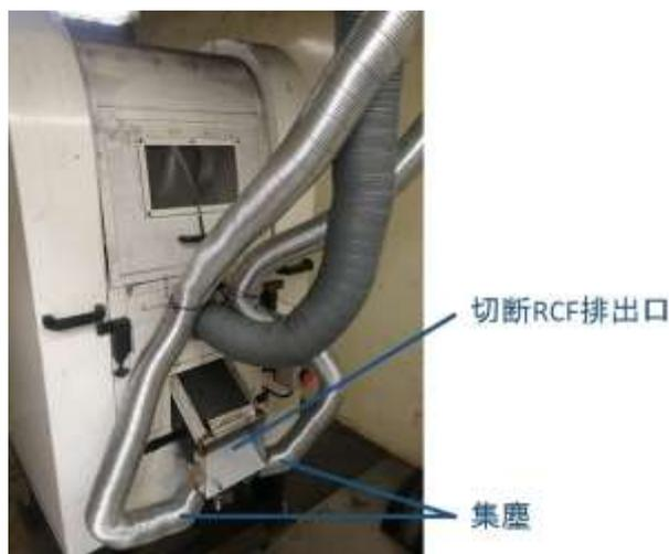
図 5.5 切断機への集塵機設置の様子
