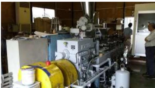
図4.2 2軸押出機（設置時）
