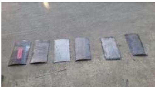
図 3.26 9等分したCNGボンベを6層に剥離したもの
