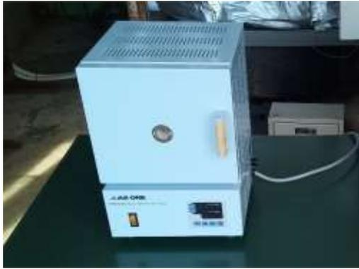
図 3.22 電気炉
