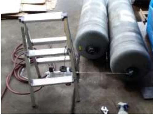
図 3.46 残ガス燃焼のため CNG ボンベを
