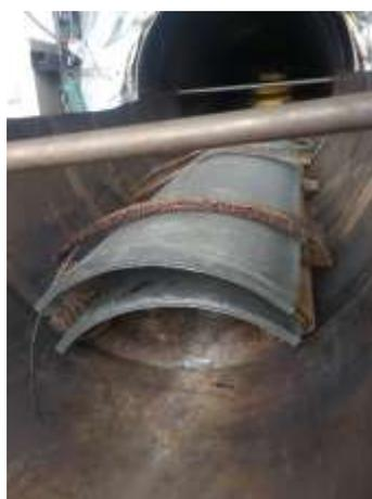
図 3.19 試料の間に隙間を作り並べた様子
