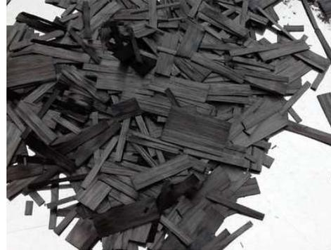
図 3.43 切断後の RCF 回収物 (25mm)
