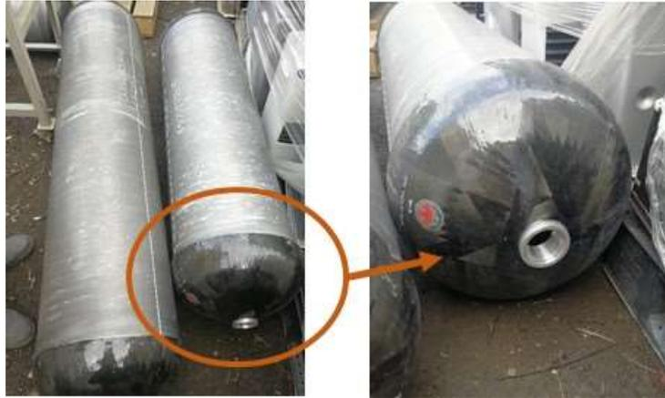
図 3.49 CNG ボンベ切断後
