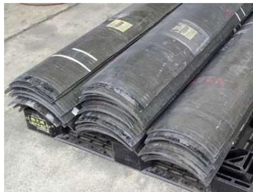
図 3.4 CNG ボンベ (燃烧処理前)
