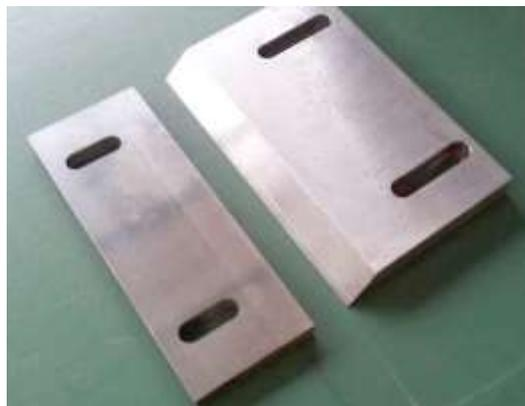
図 3.44 RCF 切断の刃（研磨後）
