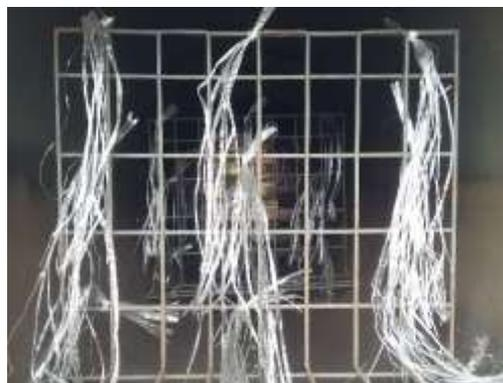
図 3.11 吹き流しを設置した反応炉内の状態
