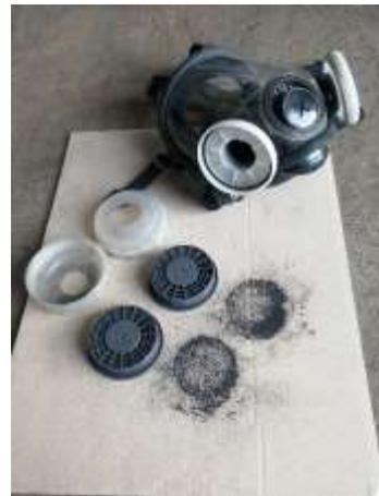
図 3.52 切断作業時の粉塵
