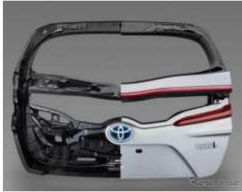
図 3.41 CFRP を使用した製品 (プリウス)
