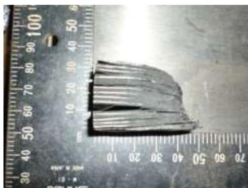
図 3.30 航空機端材 (燃焼処理後)
