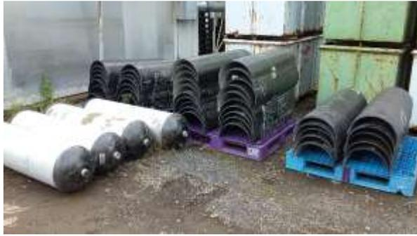
図2.2 CNGボンベ (CFRP製)
