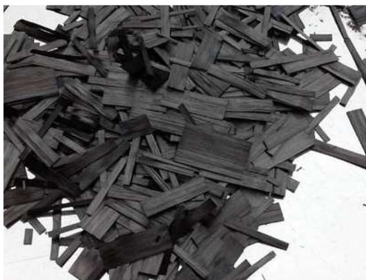
図4.6 RCF原料 (25mm切断)
