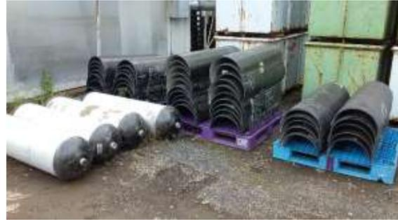
図 6.2 CFRP 前処理・回収
