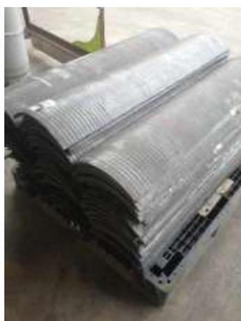
図 3.18 4 等分に切断した CNG ボンベ
