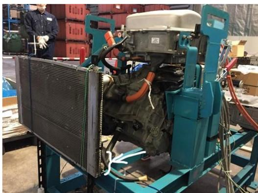
図表 63 ウォーターポンプ冷却循環試験(写真)
