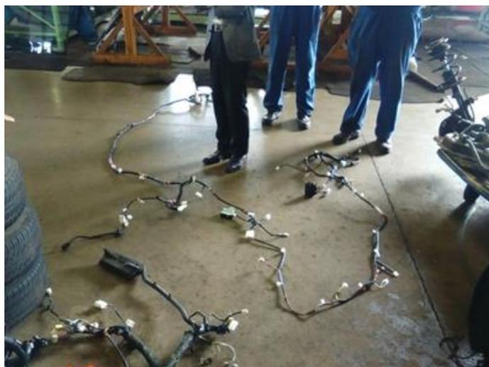
図表 13 ハーネスに取り付けられた状態の回収したコネクタ-2(写真)
