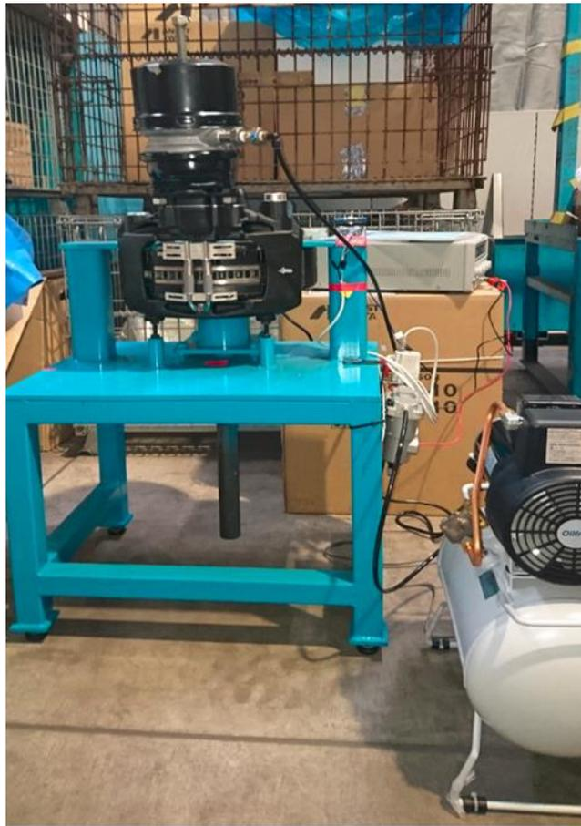
図表 54 エアブレーキ実験用回路
