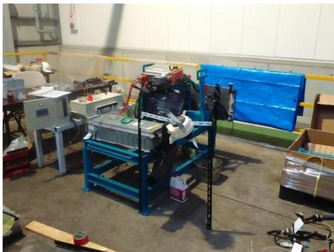
(株) ジェイテクト製TOYOPUCでトルク指令(測定:6N, 4N)を出すと、バッテリー音、インバータ音に続いて、HVモーターが回転する事が確認された(図表 16)。
