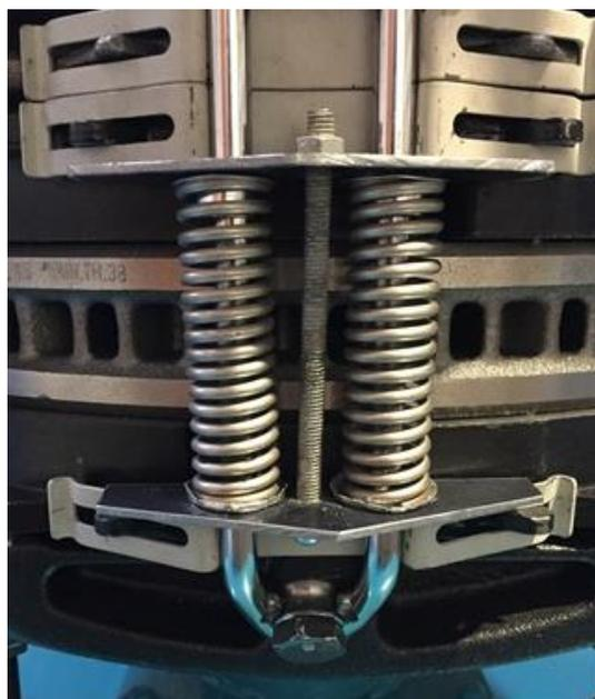
以上の作動試験及びバネ試験によりコイルバネでパッドを元の位置に復帰できることを確認、必要なバネの仕様も確定できた。
