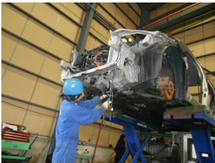
図表 8が、小林商店にて回収作業(実施日：2016/11/24)をしている様子であり、HVバッテリーの取り外し作業中である。
