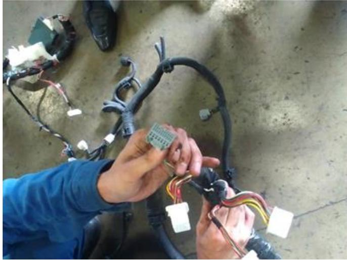
図表 14 性能(動作)試験用に新たに作成したハーネス(写真)
