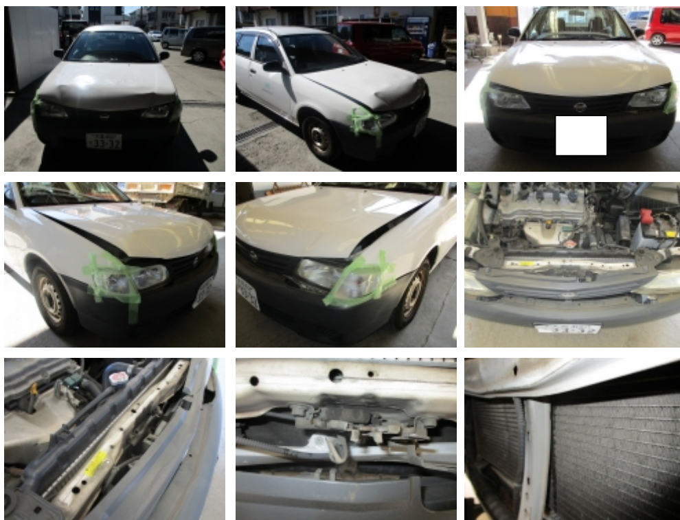
図 2-2 修理工場が撮影する損傷個所の写真(例)
