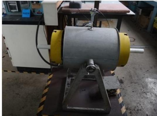
図 1.2-10 管状電気炉 写真
