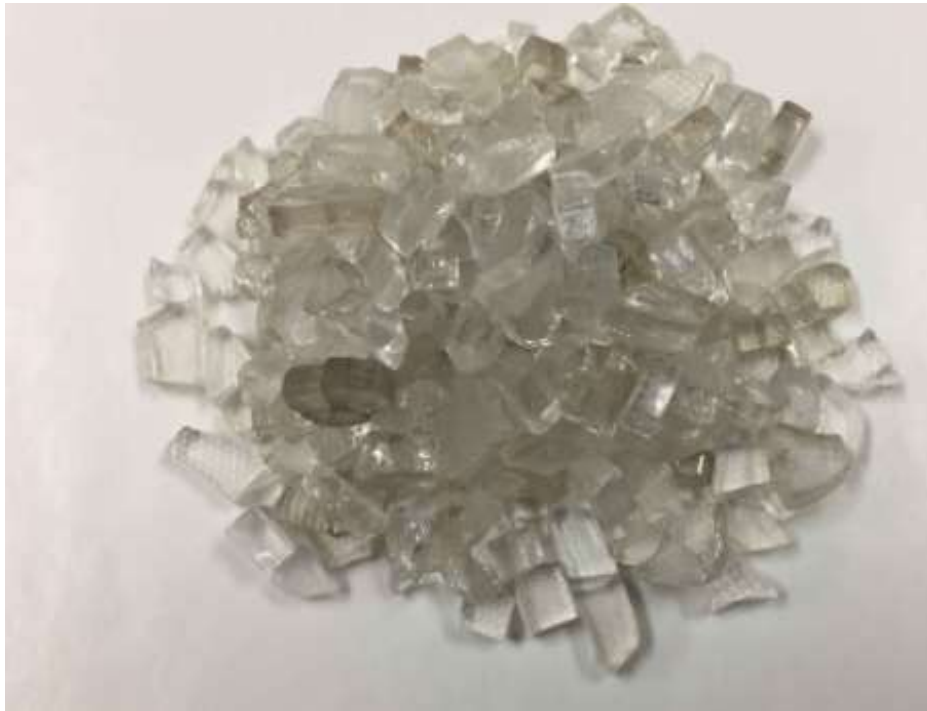
写真 3.5.5 PV ガラスカレットの外観
