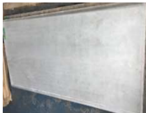
写真 3.1.8 焼成後のパネル外観③ (カバーガラスが割れていない状態)
