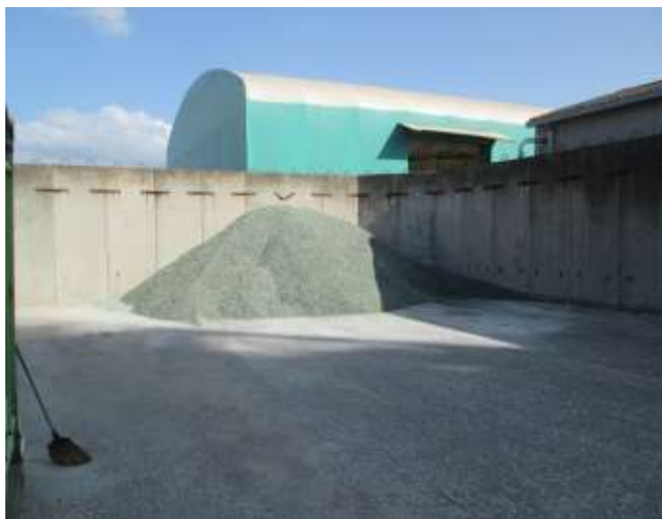
写真 3.5.3 混合後のカレット外観 (PV ガラスカレット 5%相当)
