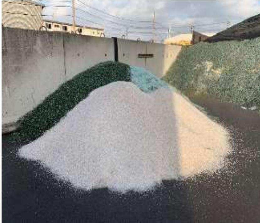
写真 3.5.9 カレット混合前の状況（手前の白いガラスが PV ガラスカレット）
