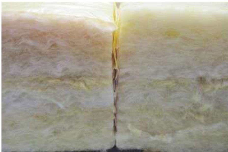
写真 3.5.13 試作品の外観（左：PV原料試作品、右：OW原料製品）
