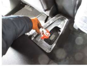
2. 室内からLIBユニットのサービスプラグを取り外す
