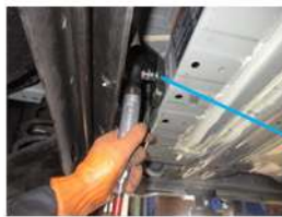
後部LIBユニット締結ねじの取り外し状況
