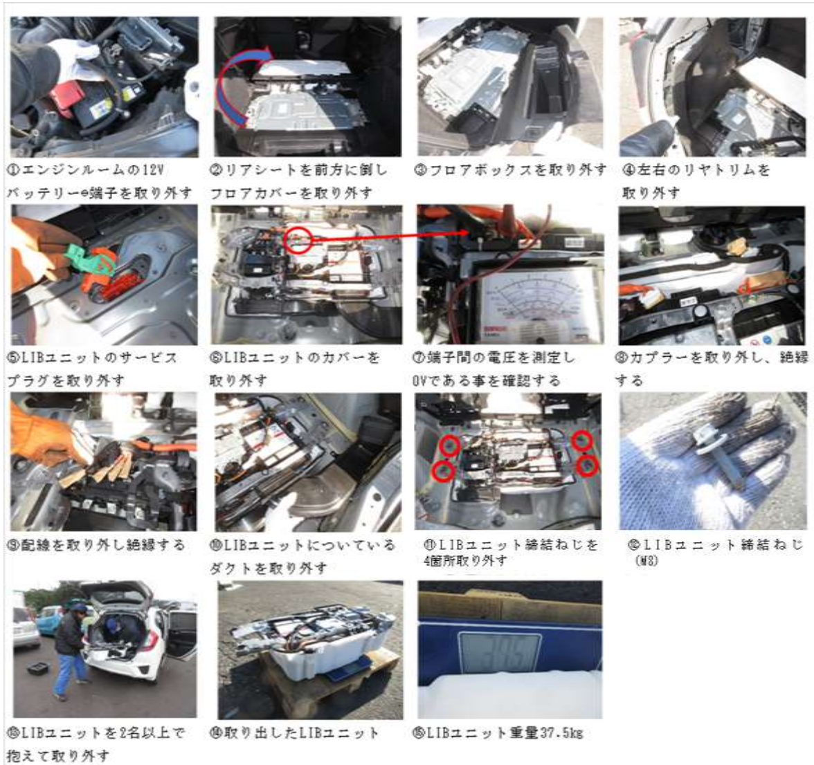
図 1.2-22 FIT3 の LIB ユニット取り出し方法
