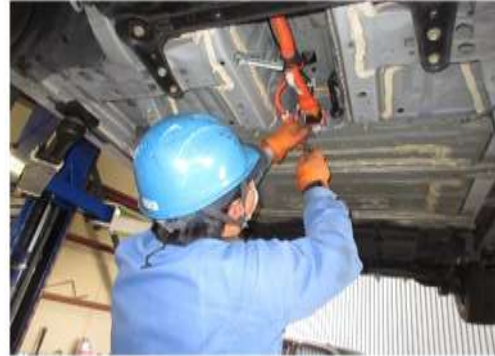
電気系コネクタ取り外し作業
