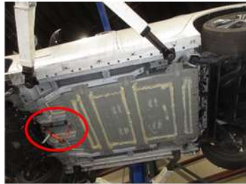
4. LIBユニットの電気系コネクタを取り外す
