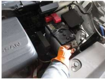
1. モータールームの12ボルトバッテリーの端子を取り外す
