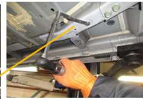
ボンディングプレート取り外し（2箇所）
