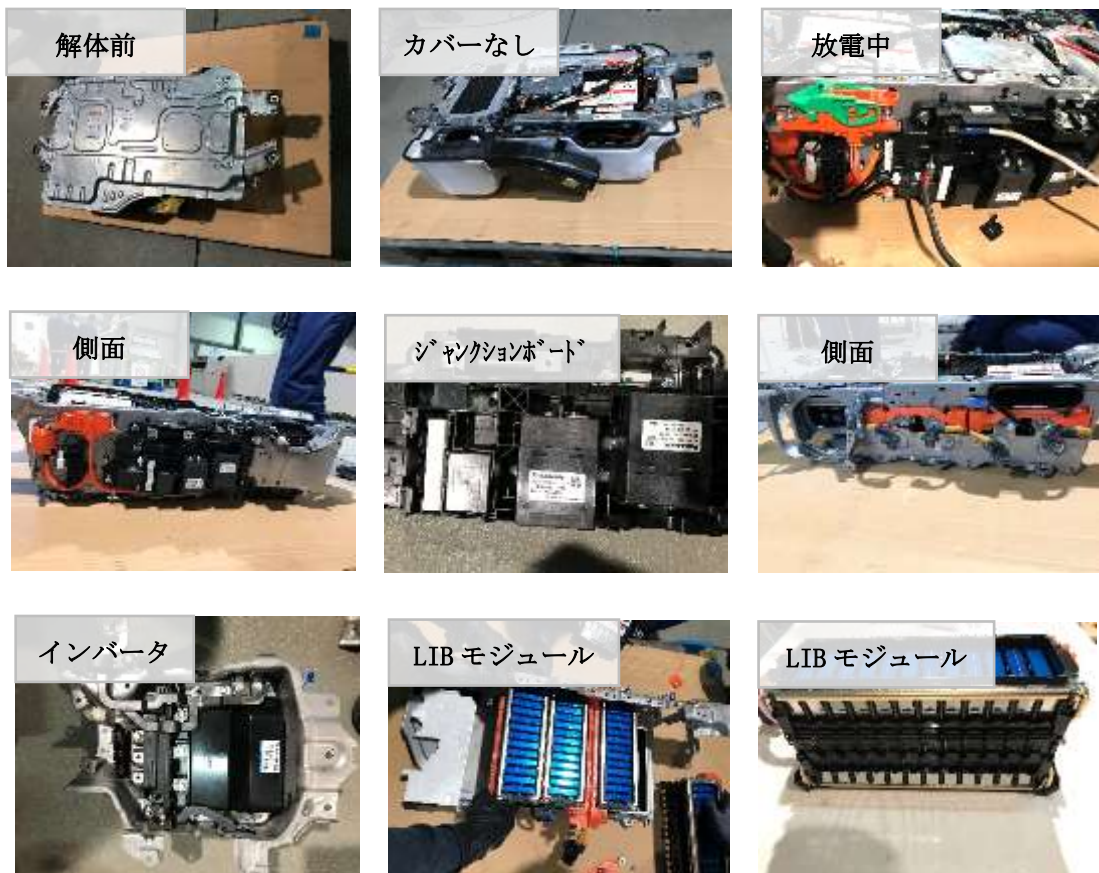
図 1.6-2 FIT3-LIB 解体状況
