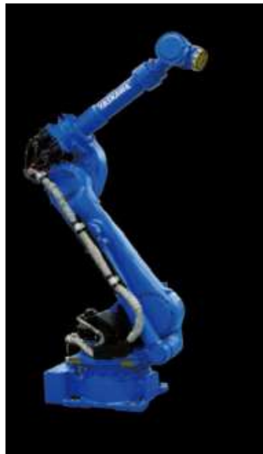
図 1.2-12 株式会社安川電機製ロボット MOTOMAN GP180-120
