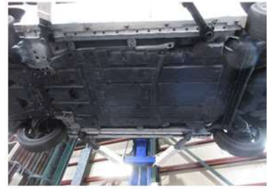
3. カーリフトで車体を上方に上げアンダーカバーを取り外す
