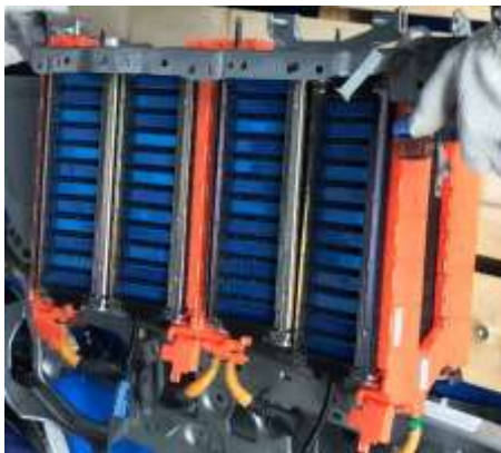
FIT3-LIB 内部のモジュールA～D
