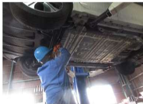
LIBユニット締結ねじ取り外し作業
