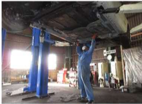
アンダーカバー取り外し作業
