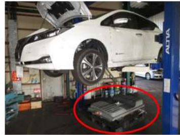
5. LIBユニット締結ねじを外しLIBユニットを車体から取り外す
