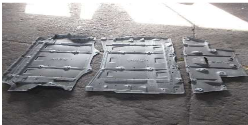
取り外したアンダーカバー
