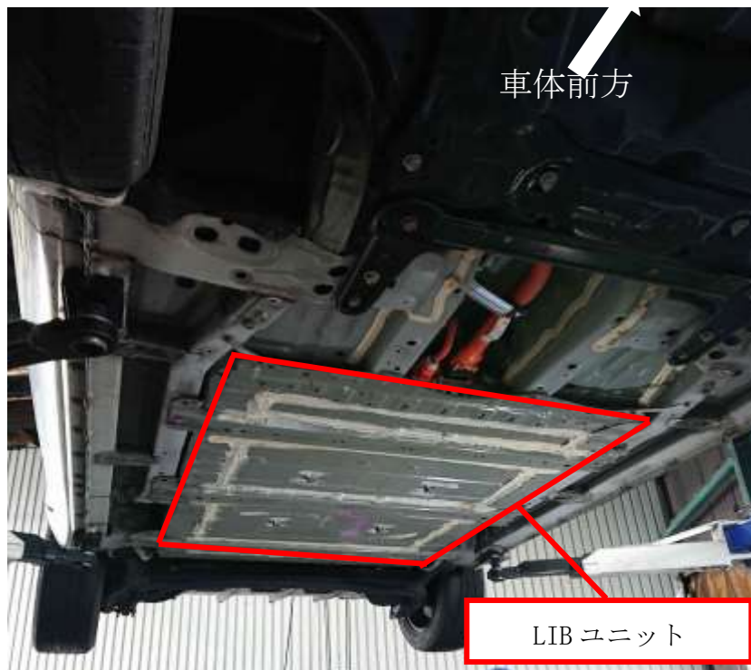
図 1.2-4 LEAF LIBユニットの車体への取り付け状態
