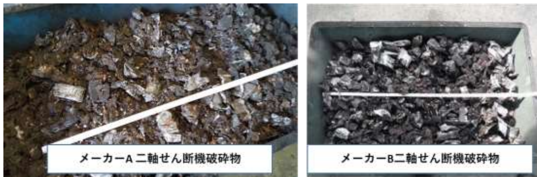
図 1.7-8 二軸せん断機破碎物
