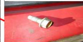
後部LIBユニット締結ねじ（M12）8本取り外し
