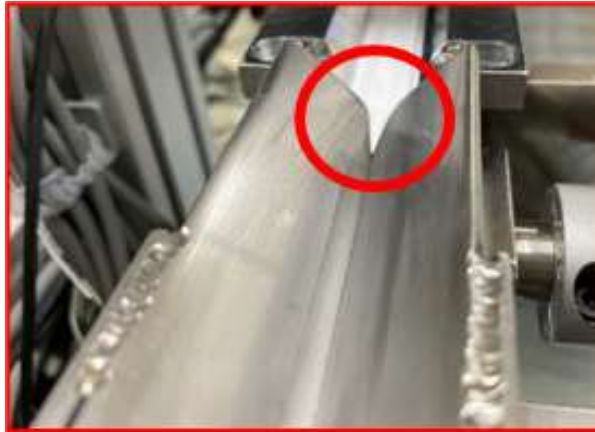
図 16 直進フィーダのV字形溝
