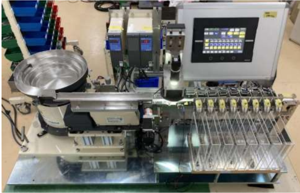
図 12 AI 画像認識選別システム全体図
