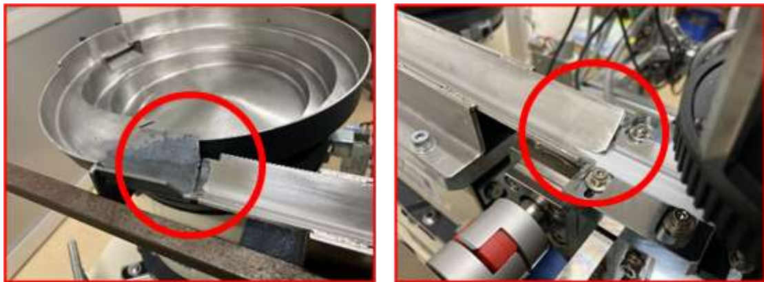
図 15 直進フィーダ始端および終端の継ぎ目
