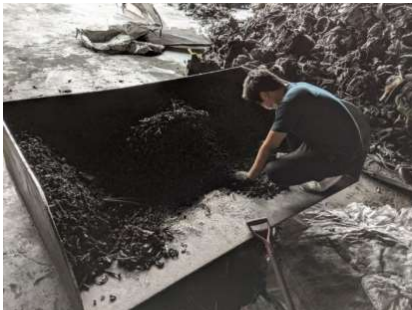
図 53 残渣中の着火プラグをピックアップしている状況
