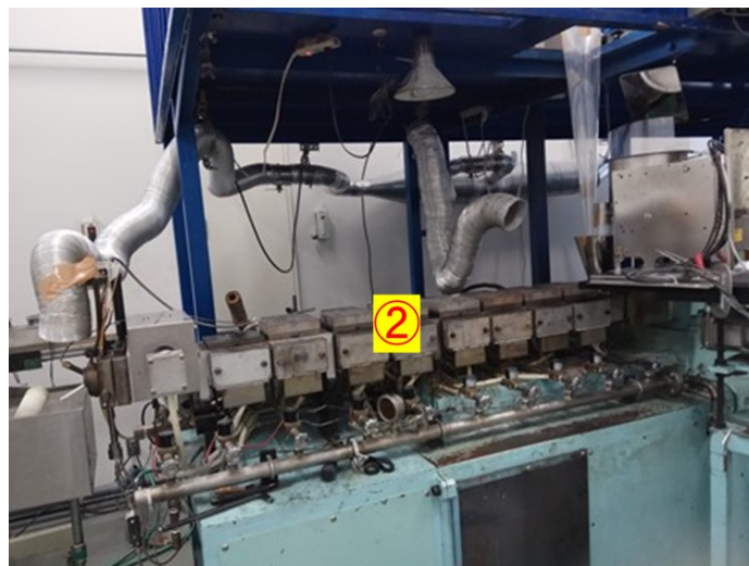
図 3-5 ツインスクリーによる混練
