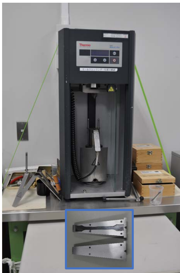
図 2-4 試験片成型用小型射出成型機と金型
