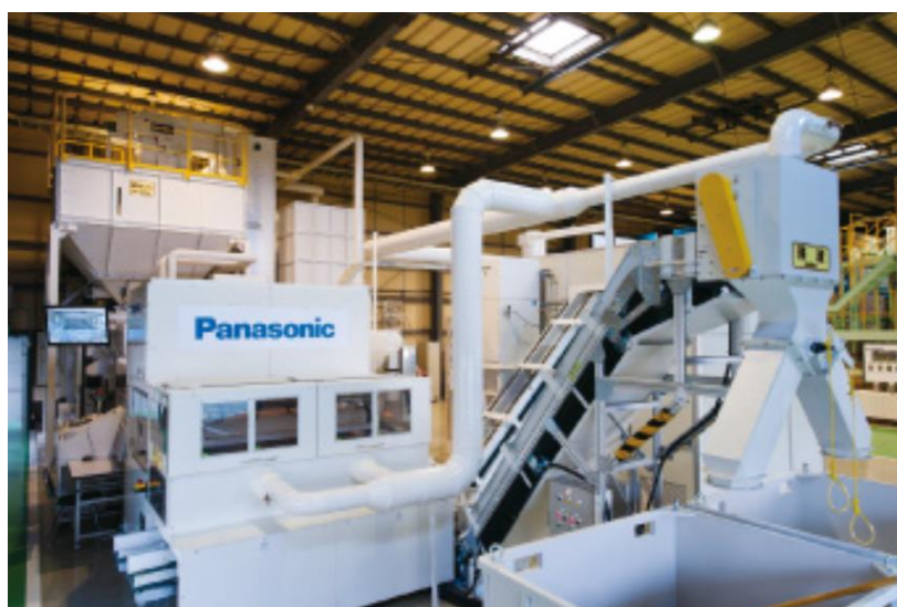
図 2-48 近赤外線樹脂選別機外観写真
