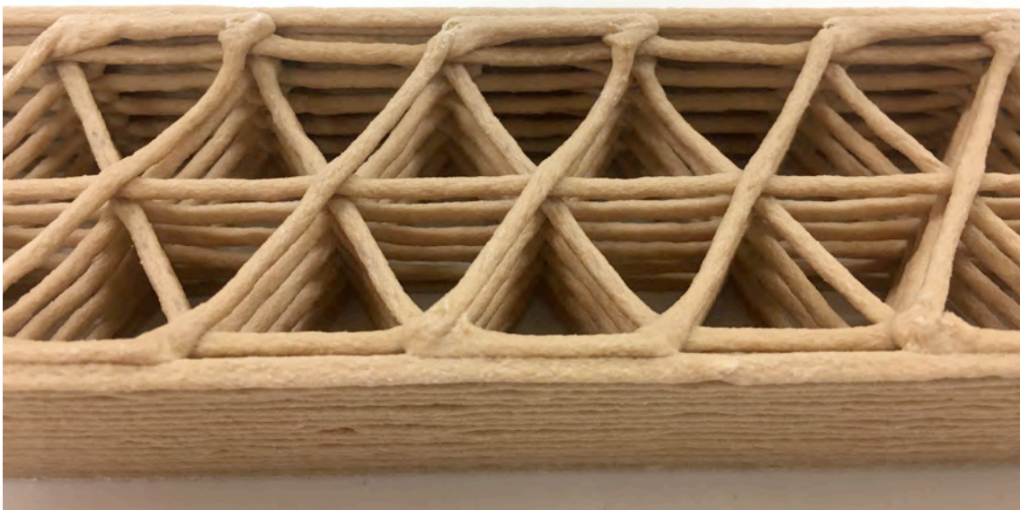
図 1-14. セルロースファイバーが 210℃程度の造形温度で劣化、ガスが発生し発泡した
