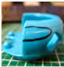
収縮により、層が裂ける
