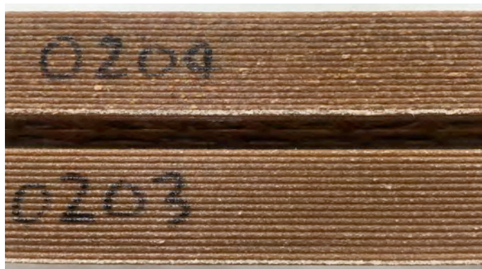
圖 1-21. SBC818 / 木紛 1000 \mu\text{m} 以下(上)、SBC818 / 木紛 178 \mu\text{m} 以下(下)を比較
