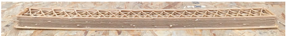
図 1-8. LDPE:SBC818 ベース 造形試験結果
