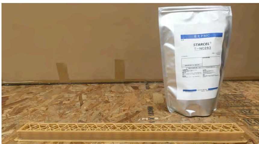
図 1-3. LLDPE ベース T-NC283 造形温度 210°C 造形試験結果
