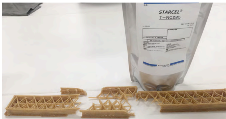
図 1-4. HDPE ベース T-NC285 造形温度 260°C 造形試験結果
