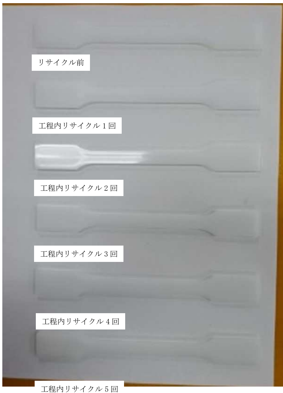
図 2.7.2.2 工程内リサイクル回数の増加による材料外観の変化(PE)
