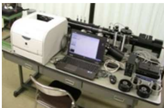
図 1. 2. 1. 1. 1 垂直入射吸音率測定装置 (WinZacMTX)
