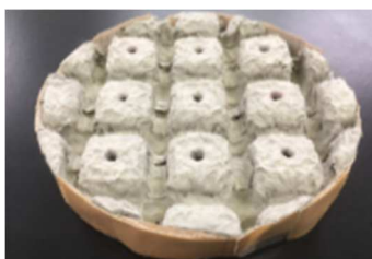
図3.1.1.1 パルプ繊維による自動車吸音材
