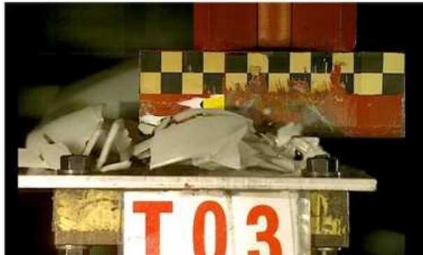
図 2.6.6 各試験体の破壊状況(パルプ添加無し)
