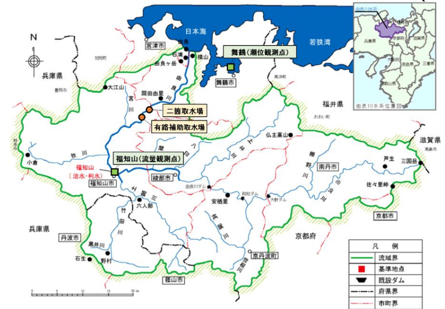
図 由良川における利水施設及び舞鶴市の取水場、流量・潮位観測点の位置
