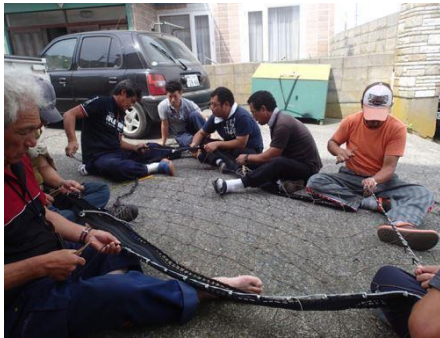
状況に応じて海上で格子網を取り外すことができるよう、外周にファスナーを装着するなどの工夫を施す
