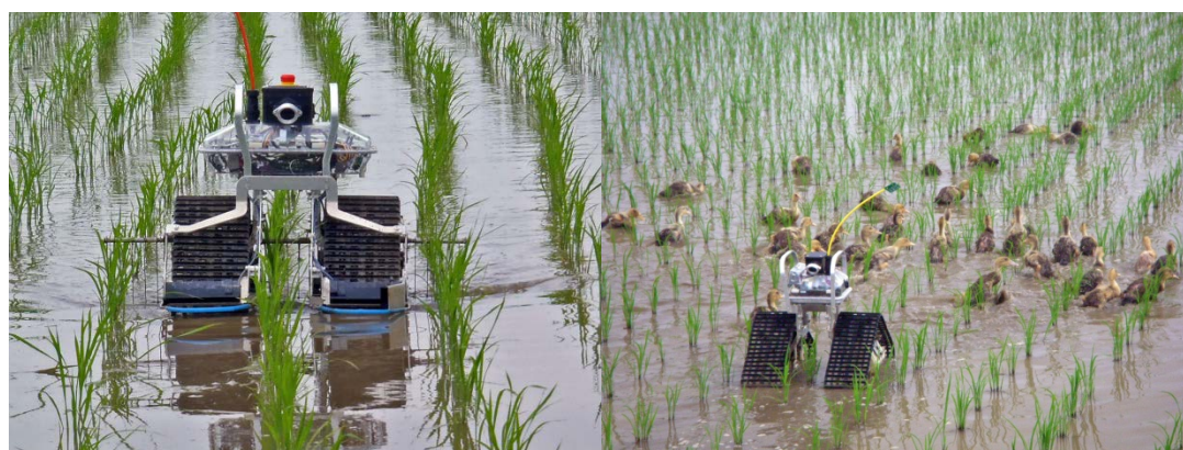
図ー19 水田用小型除草ロボット（アイガモロボット）
