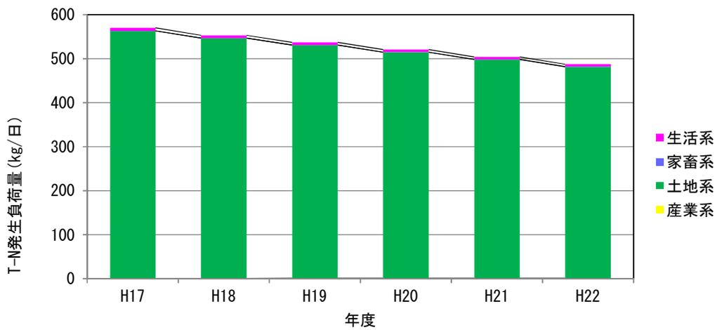
図 2.5.6 川治ダム貯水池流域のT-N発生負荷量経年変化
