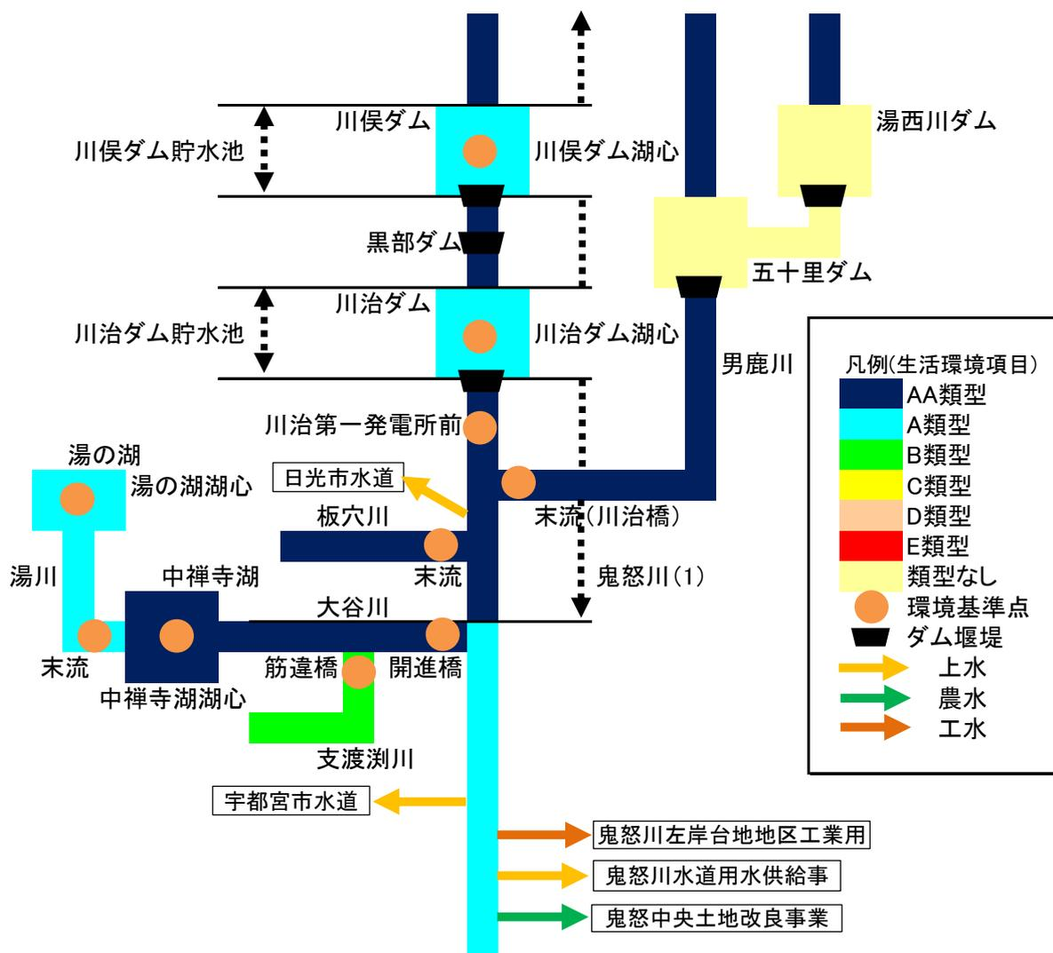
注) 川治ダム放流水は栃木県等に水道用水を供給。浄水場では、急速ろ過及び急速ろ過・塩素処理方式が採用されており、水道2級(AⅡ類型相当)に相当する。利水障害の報告はない。図示した範囲より下流にある平方流量観測所(茨城県下妻市)における流域面積と川治ダム貯水池の流域面積比は、5.0。
