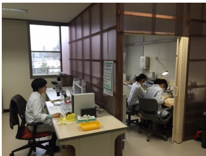
写真 6 分析室。ホルマリンを含む海水処理のため、安全を考慮して換気を強化した別室を作成した。
