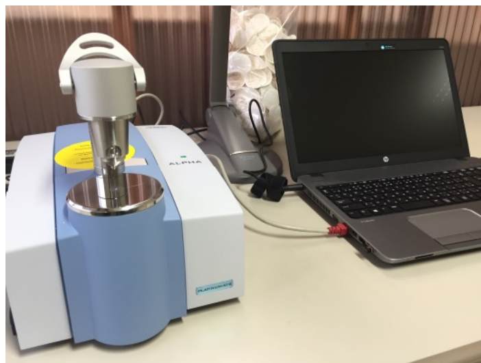
写真3 材質判定に用いた FT-IR
