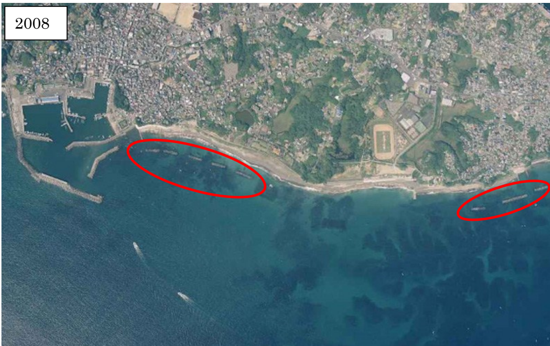
図 4-2 「31 広ノ浜」における 1975 年と 2008 年の海岸線の比較；隣接する港が拡大され、さらに多数の離岸堤が設置されている。港の近くでは砂が減っているように見える。
