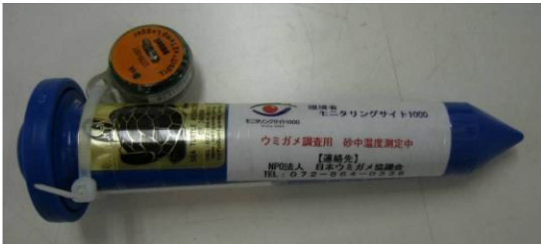
図1-7 データロガーを水道管工事用マーカーと結合した状態
