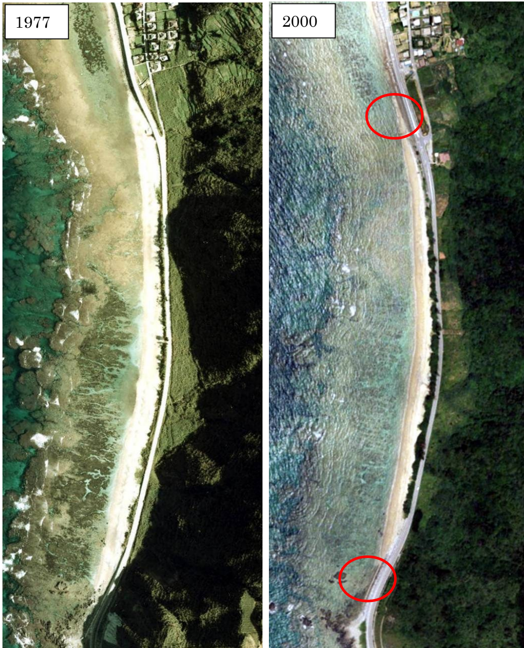
図 4-3 「8 沖縄島 謝敷海岸」における 1977 年と 2000 年を比較；砂浜は全体的に幅が狭くなっている。また北側と南側が数十 m ほど短くなっている。砂が流出し、全体的な砂の量が減少していると考えられる。
