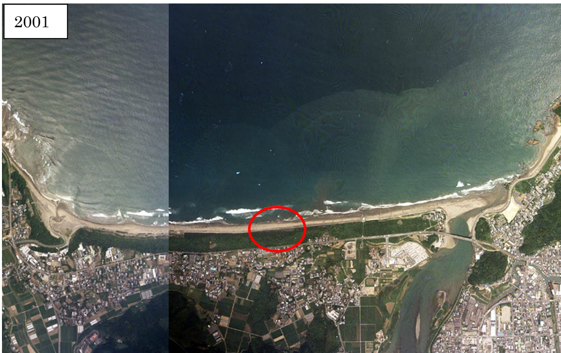
図 4-4 「19日南海岸」における 1974 年と 2001 年の海岸線の比較；砂浜全体にわたり幅が狭くなっている。特に 1974 年に中央部でみられた幅の広い部分が 2001 年に消失している
