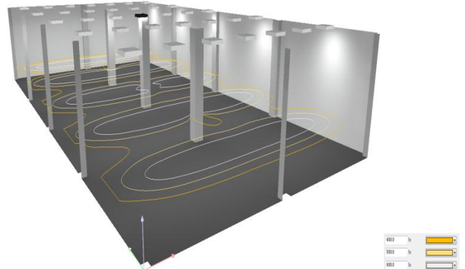
図4 計算結果 - 作業面の照度分布（例）
