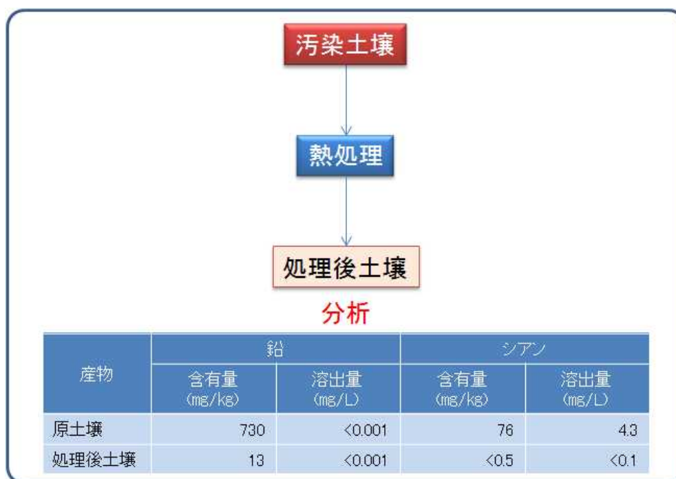
浄化等処理施設（浄化（分解－熱分解））における適用性試験結果の例
