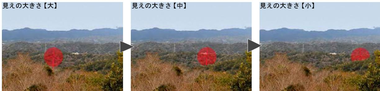
写真11 地形を活かした風力発電施設の遮蔽による効果のシミュレーション
