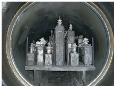
(紙を絶縁紙に使用した コンデンサの処理後)
