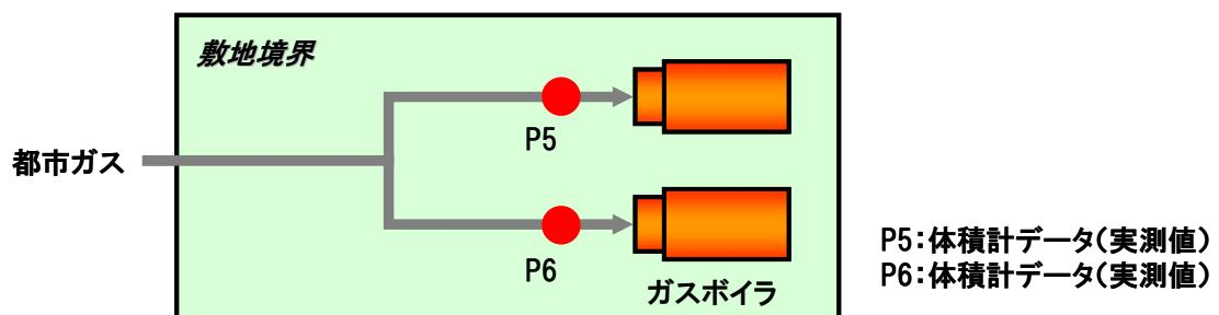
【例5】外部供給(事業所内で燃料を使用して電気や熱を発生させ、外部へ供給した場合)
