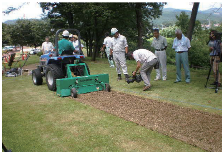
図-2-30：芝地の除染作業の例
