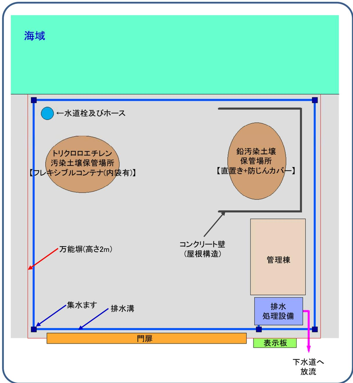
図 2.1.2-3 保管施設の配置図の例
