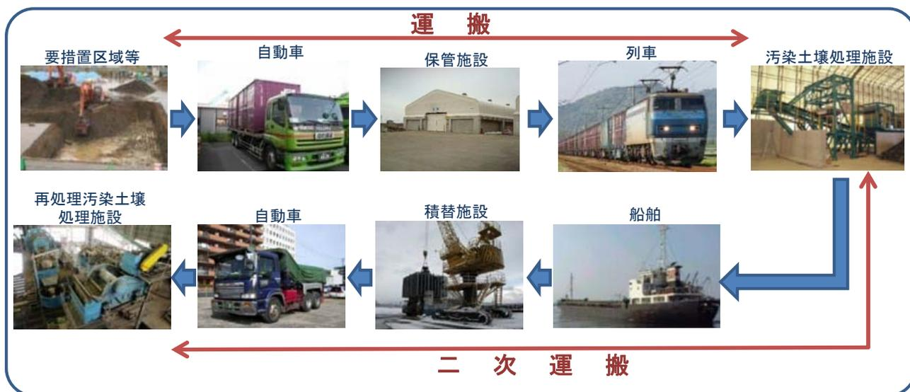
図 1.5.1-1 要措置区域等から再処理汚染土壌処理施設までの運搬の例
