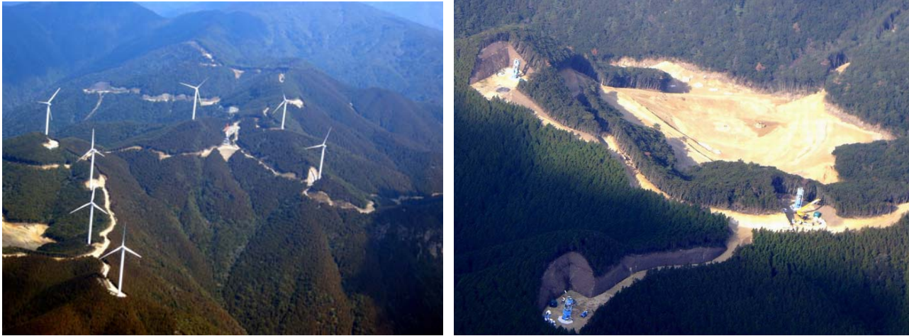
図 7-1 0 尾根伝いに風力発電所の付設及び取付道路の建設による土地改変の例 (A風力発電所) 27)
