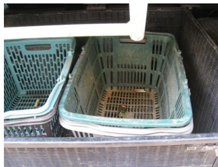
パッカー車に籠を設けて運搬
