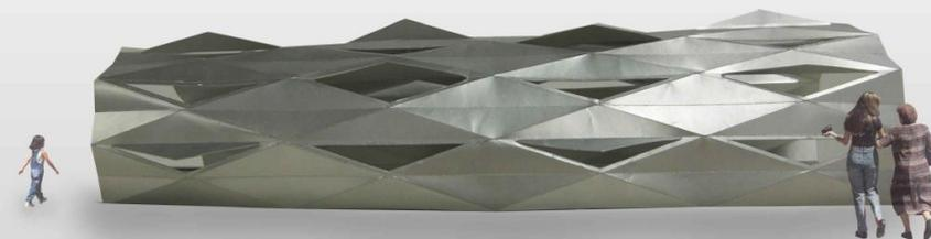
ガラス繊維にプラチナ微粒子を吹き付けた1枚のシートを折り紙のように折り曲げた形。下からベンジンを気化させプラチナの触媒作用で発熱する。触媒を用いないで燃焼させるとベンジンは数分で燃え尽きてしまうがプラチナ触媒を用いると24h温かさを持続させることができる。
