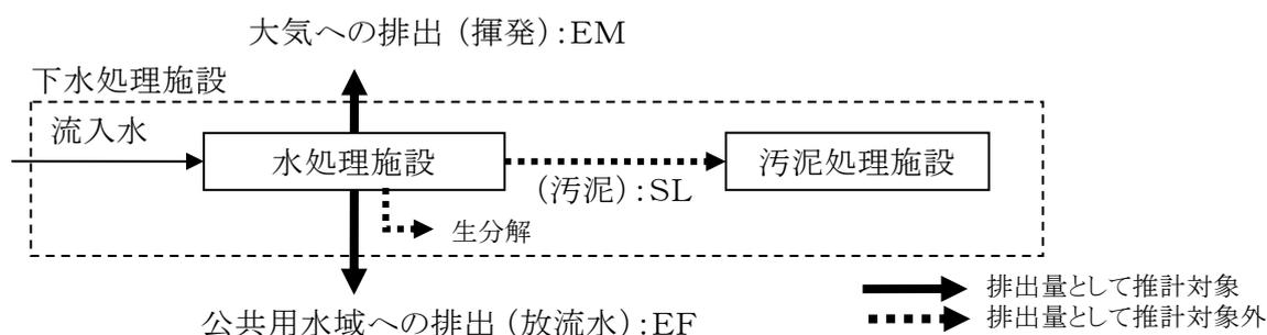
図 0-3 簡易推計式に基づき設定される移行率のイメージ
