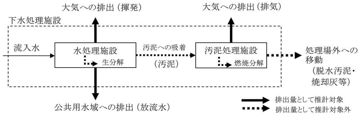
図 0-2 下水処理施設における対象化学物質の排出等の考え方
