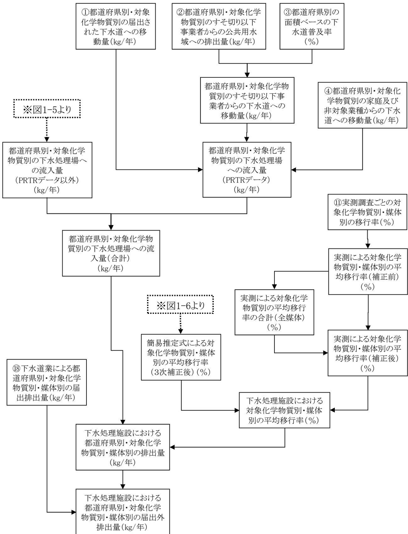
図 0-4 下水処理施設に係る届出外排出量の推計フロー (その1; 全体フロー)
