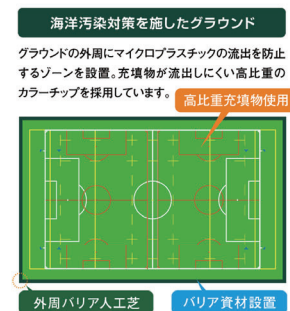
海洋汚染対策を施したグラウンド
