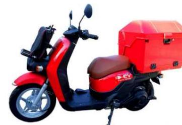
バッテリー交換式電動二輪車
