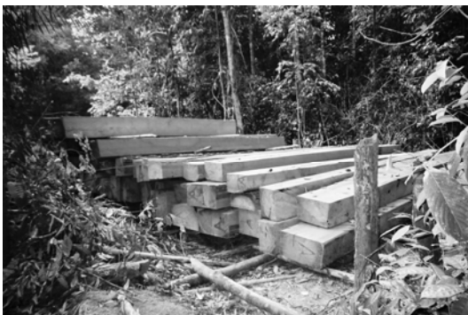
(写真 5) 土場(2002 年 7 月撮影) 国立公園内。伐採場所でチェーンソー製材される。切り口に書かれているのは伐採者のサイン。
