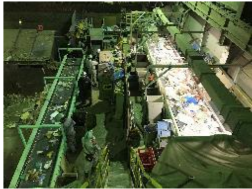
産廃選別ラインからのピッキング
