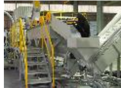
選別 (水/振動/風力/静電/光学 等)
