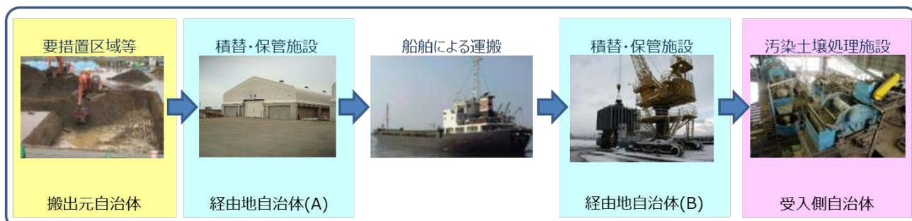
図 2.1.1-3 積替・保管施設を経由する運搬の例
