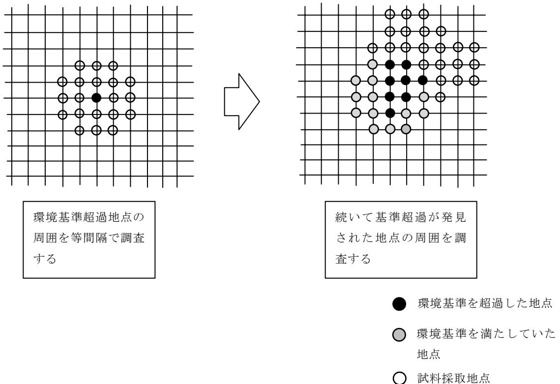
図-5. 汚染範囲確定調査の試料採取地点の設定例
