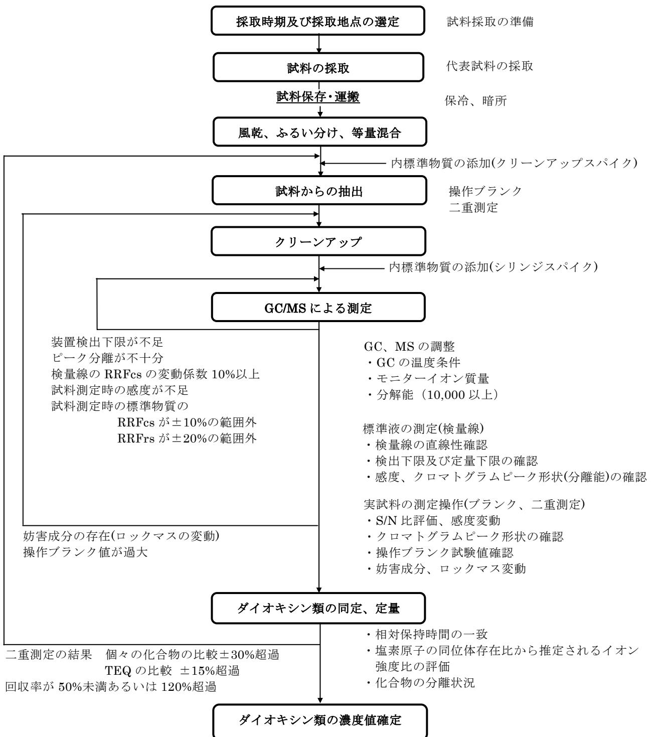
図-1. 試料の採取から測定の流れ
