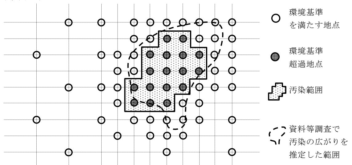
図-6. 汚染範囲確定のための調査の例
