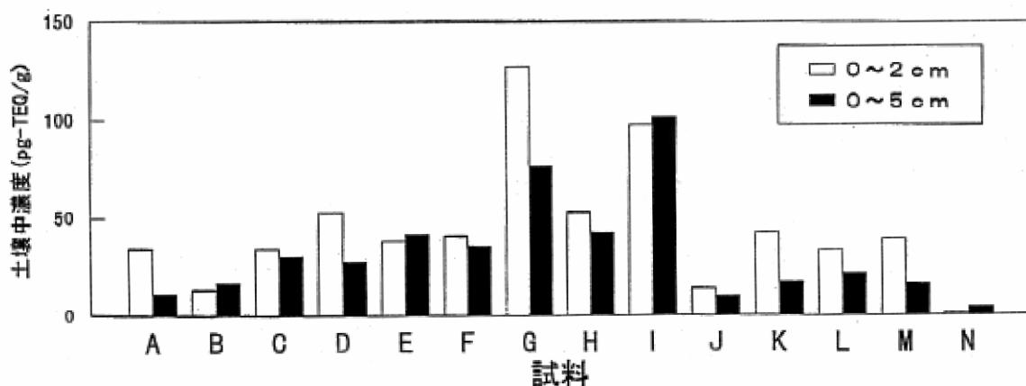
図D 試料採取深度と土壌中ダイオキシン類濃度の関係
