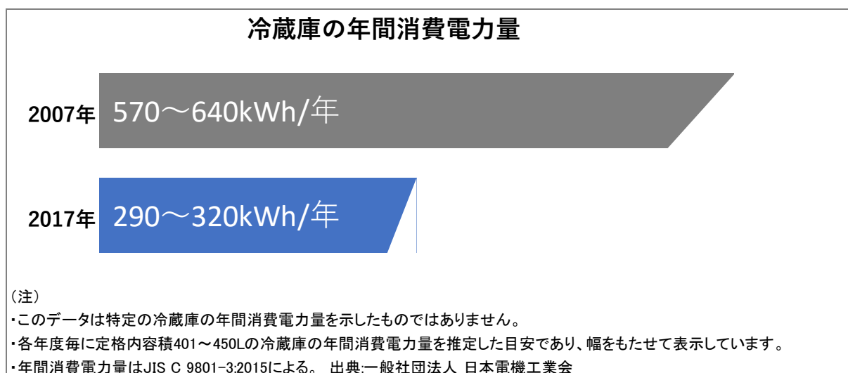
図 11 製造時期による冷蔵庫の年間消費電力量の比較
