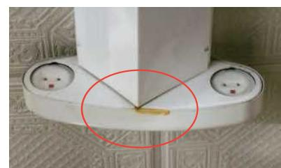
蛍光灯安定器の劣化により蛍光灯機器からPCB油が漏れ出した例
