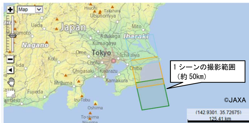
図 2-1 ALOS-2 の観測範囲の例(北行軌道の例)
