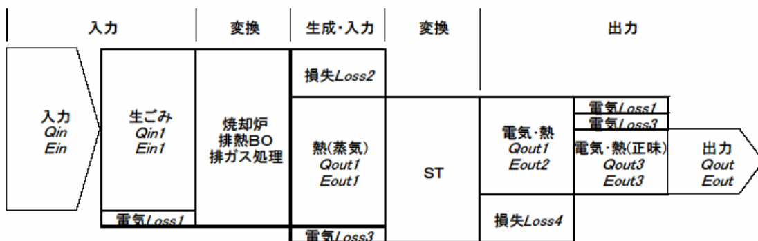
図4 直接焼却発電システムエネルギー収支フロー
